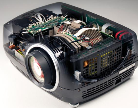
L'engine ottico RealLED di seconda generazione, brevettato da Barco, consente una luminosità di 900 lumen (equivalente ai 1.400 lumen di un proiettore dotato di lampada tradizionale).
