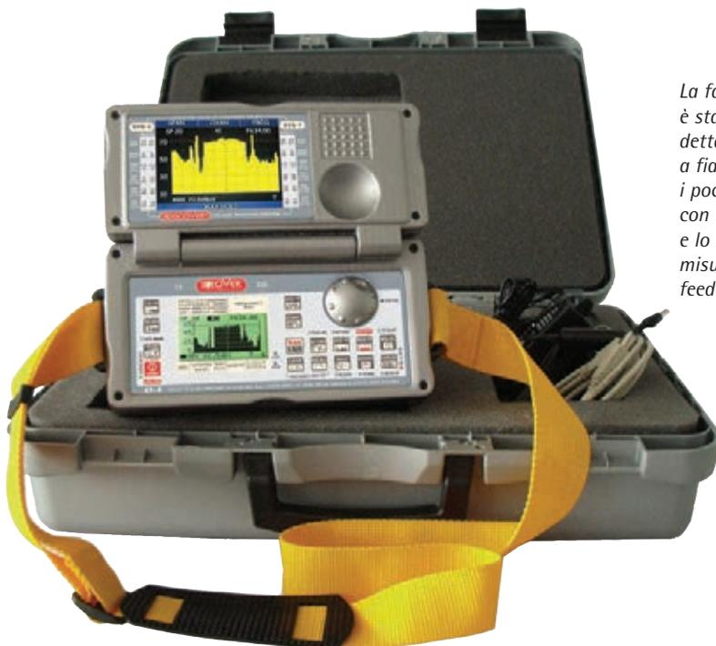
*La facilità d'uso dell'ST4 è stata curata nei minimi dettagli: nella pagina a fianco sono riportati i pochi tasti da utilizzare, con la manopola Encoder, e lo switch utilizzato per misure di impianti dual feed*
