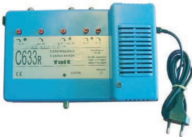
Il C633R (dove R sta per Roma) è un centralino a 3 ingressi per le bande I, III/IV con l'aggiunta del canale 43 in banda V, con guadagno di 35 dB e massimo livello indistorto di 116 dBμV. E' dedicato espressamente alla zona romana caratterizzata, come gli installatori ben sanno, da una copertura dei segnali provenienti da due postazioni diverse : Monte Cavo e Monte Mario.
