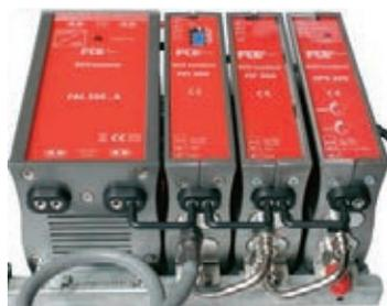
La centrale PP8 è stata studiata per l'edilizia residenziale, in quelle ristrutturazioni dove non vi è spazio per cablare nel montante i 4 cavi tipici di un impianto a multiswitch. E' in grado di gestire un elevato numero di prese utente, dalle trenta in su. La versione PP8 EVO è un ampliamento della PP8 base: è
