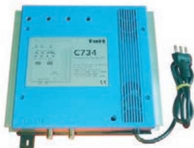
L'alimentazione viene effettuata dalla tensione di rete a 220 V.c.a. e le dimensioni sono molto compatte, se paragonato alla centrale della pagina qui a fianco, che offre caratteristiche paragonabili. Le sue misure sono cm 22,2 x 24,5 x 5,8.
