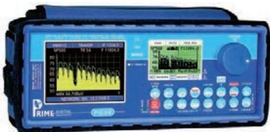
Con il nuovo PD 32, un analizzatore combinato Tv/Sat/FM, digitale e analogico, Prime Digital sfida il concetto che uno strumento per essere preciso, efficiente e robusto debba occupare molto spazio e pesare almeno 5 Kg. Questo nuovo modello pesa poco più di 2 Kg., è resistente agli urti, alla pioggia, alla polvere e può così essere impiegato anche nelle situazioni più difficili. Esegue tutte le misure necessarie all'installatore per verificare il perfetto funzionamento dell'impianto.
