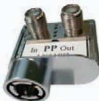
Il partitore per presa PP dedicato alla banda terrestre, ha una perdita di passaggio pari a 3,5 dB in banda I, III, IV e V. L'isolamento fra le derivazioni è di 20 dB e permette il passaggio di corrente continua. E' disponibile anche una versione adatta sia ai segnali satellitari che terrestri, dalle stesse caratteristiche (la perdita di passaggio sat è di 4dB) dotata di uscite a diodi di protezione.
