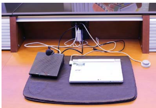
Una delle postazioni della sala, con PC, microfono e pulsante di prenotazione. Posizionati dietro un pannello di copertura, i cavi di collegamento con i trasmettitori.
