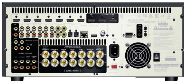
Gli ingressi HDMI disponibili sono sette. Le tre uscite HDMI sono state previste per supportare il multi display nella Zona Principale (ad esempio, monitor/TV e proiettore) e la riproduzione Full HD con audio nella Zona 2.
