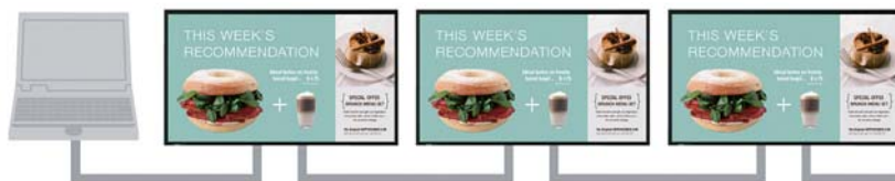
Modalità 'straight cable': più monitor, via RS-232C vengono collegati in serie per una gestione remota.
