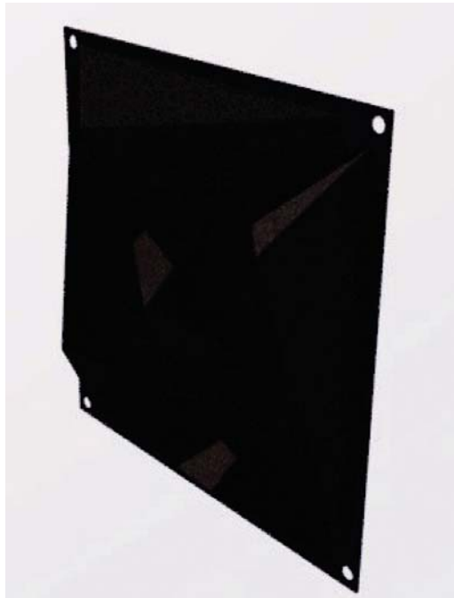
La superficie irregolare del pannello scattering, formata da tratti a pendenza diversa. Le dimensioni sono di cm 30x30.
