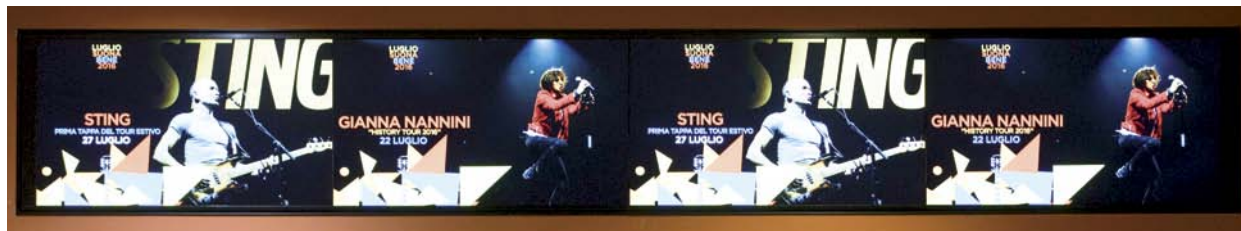
Il videowall 1x4 è stato realizzato con quattro monitor Sharp PN-V551, da 55" e 700 cd/m 2 .
