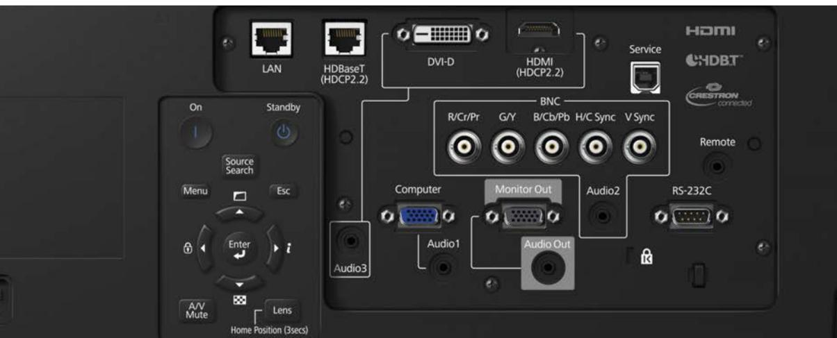
La dotazione di interfacce prevede numerosi ingressi digitali e analogici. La presa HDBaseT è disponibile separata dalla presa LAN per evitare l'utilizzo di uno switch
