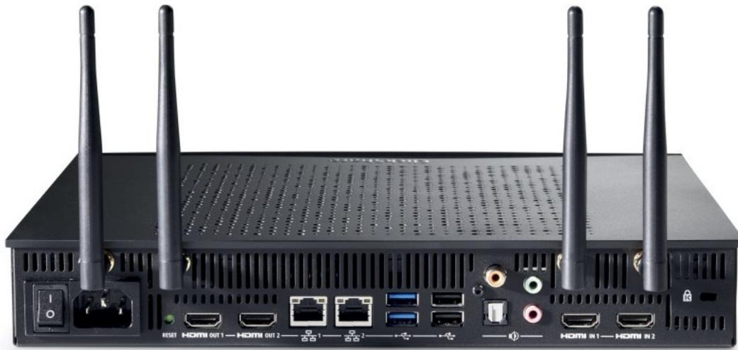
Il pannello posteriore del CSE-800. Ai lati si riconoscono i due ingressi HDMI (a destra) e le due uscite HDMI (a sinistra)
