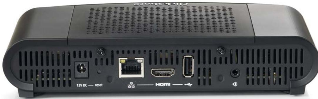
Le interfacce presenti sul pannello posteriore comprendono la Lan da 1200 Mbit, l'uscita HDMI e la USB. Una seconda presa USB è presente sul pannello frontale
