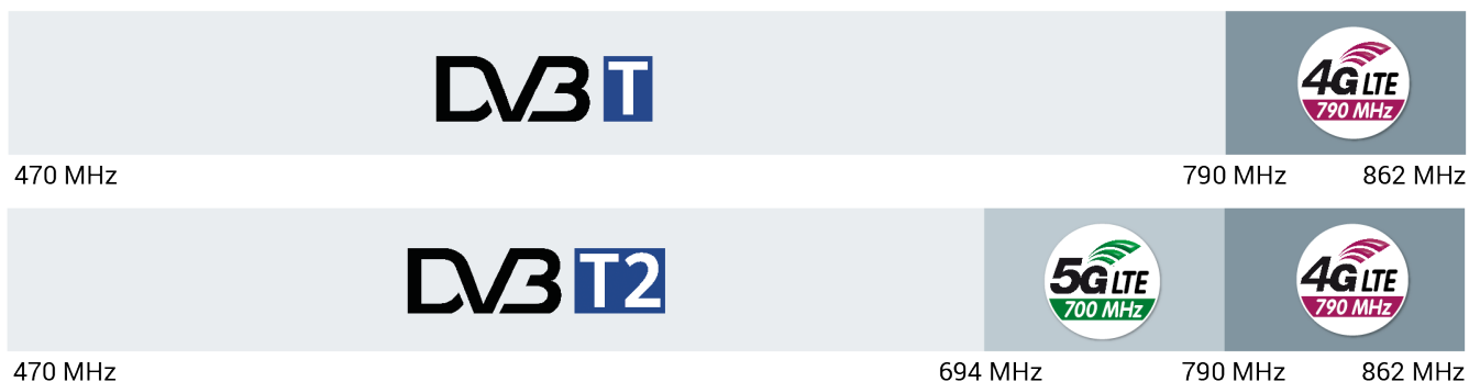
Sopra, l'antenna elicoidale Fracarro Elika; i suoi elementi ad anello garantiscono lobi laterali più contenuti e riducono il rischio di interferenze. Sotto, confronto tra l'attuale distribuzione delle frequenze e il nuovo Piano Nazionale (PNAF).
