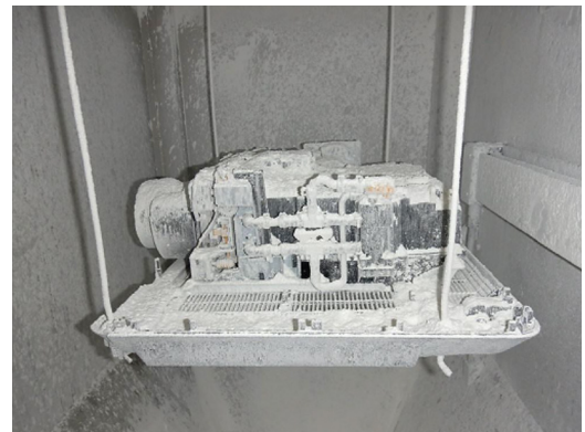
Nella foto in alto: i proiettori EB-PQ2000 sono certificati IP5X: sia l'optical engine e la sorgente luminosa sono sigillati. Sopra, una fase del test per ottenere la certificazione.
